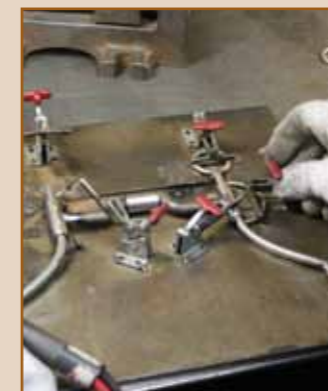
Het bit wordt in elkaar gezet op het plaatje
