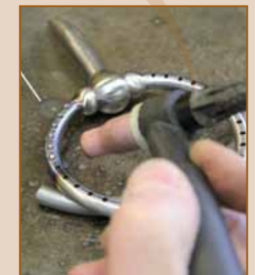
Dots op het bit maken
